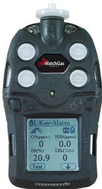
Die POLI-Multigas-Geräte (MP400 / MP400P / MP400S) ermöglichen eine Überwachung von bis zu 5 Gasen gleichzeitig. Darunter Sauerstoff, brennbare und toxische Gase sowie flüchtige und organische Verbindungen (VOCs).
